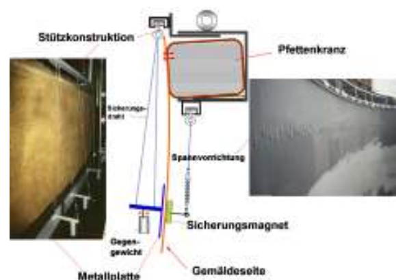
Abb. 7: Damit das Gewebe des Gemäldes während der Umbauarbeiten nicht ausreißen konnte, sind zur Sicherung des Gemäldes 1323 Magnete auf der Bildvorderseite angebracht worden.
